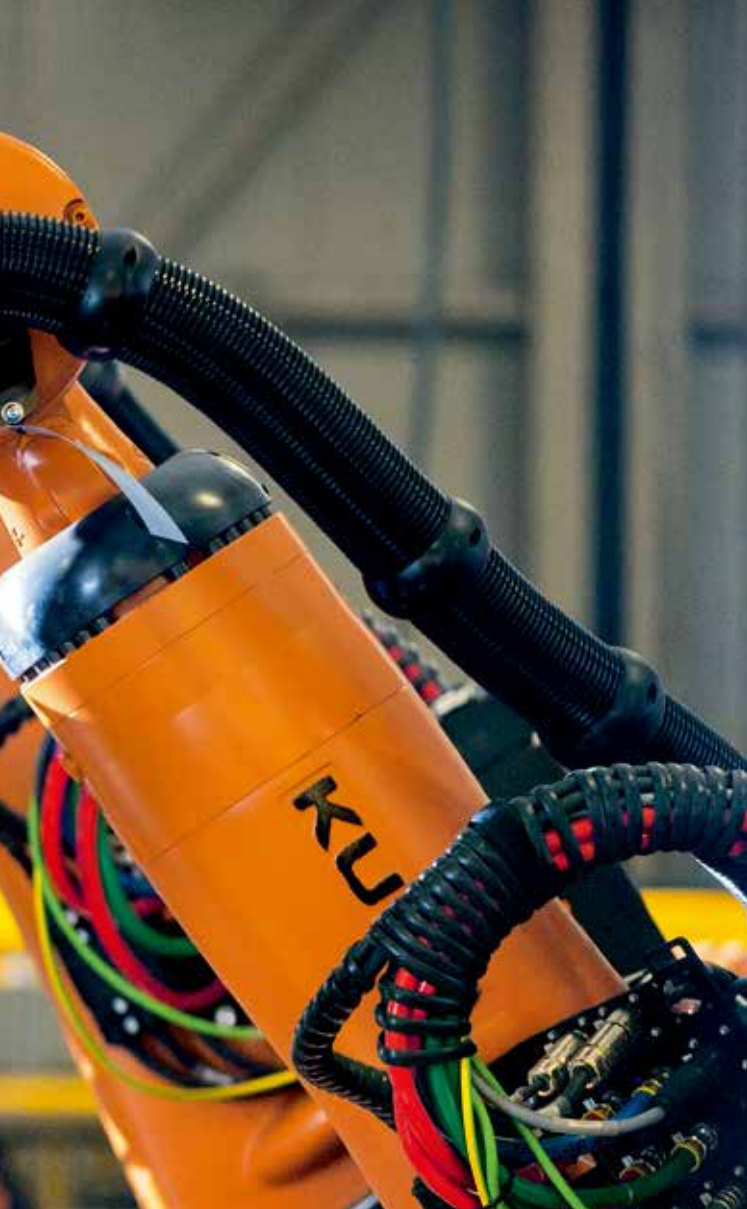
机器人在高度自动化的 BIW 零部件装配中起主要作用：她们焊接各个冲压废料和零部件，以构建车身框架结构
