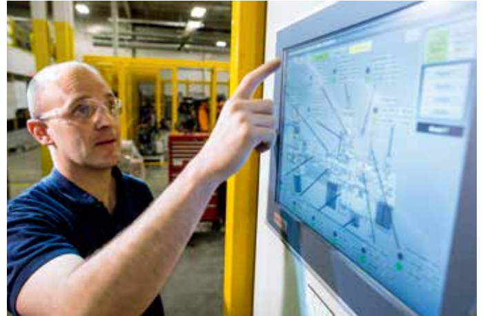
装配单元由一台 15 英寸的信福 CP6202 面板型 PC 控制
